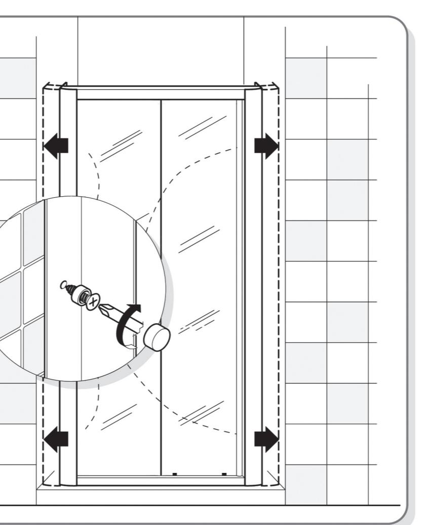
Decidete il senso di apertura (il box è reversibile) appoggiate il box doccia sul piatto con i compensatori inseriti, facendoli aderire lentamente al muro.
