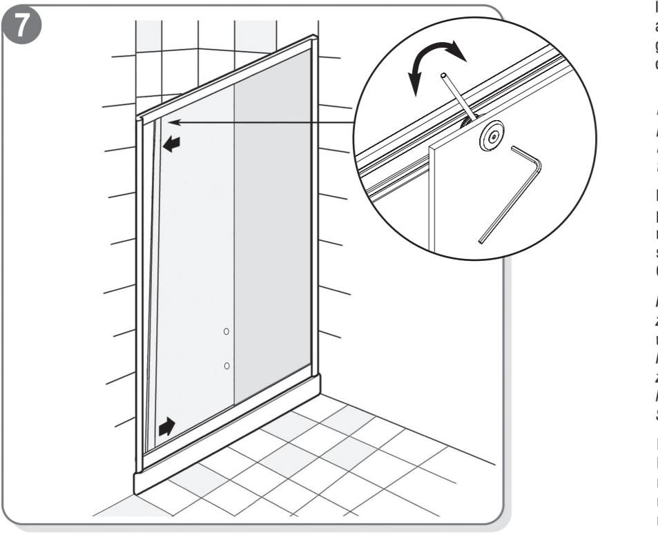
In caso di un impreciso allineamento delle due ante, allentare la vite della ruota superiore, regolare il fuori quadro dell'anta e serrare saldamente.
