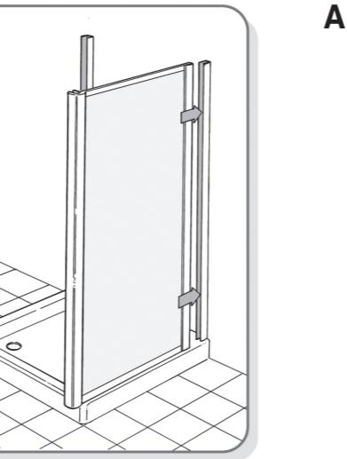
**A Istruzione di montaggio FISSO**
