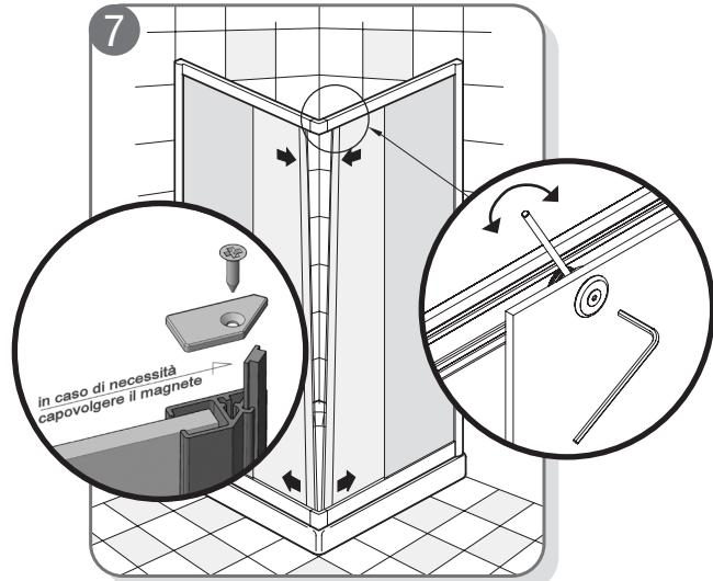
**7** In caso di un impreciso allineamento delle due ante,allentare la vite della ruota superiore, regolare il fuorisquadro dell'anta e serrare saldamente.
