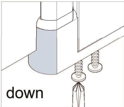
Per invertire il senso di apertura smontare ed invertire la posizione dei due supporti (vedi figura)
