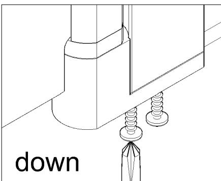
Per invertire il senso di apertura smontare ed invertire la posizione dei due supporti (vedi figura)
